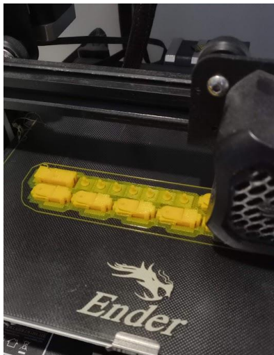
3 Het digitale model wordt uitgeprint op de 3D printer
