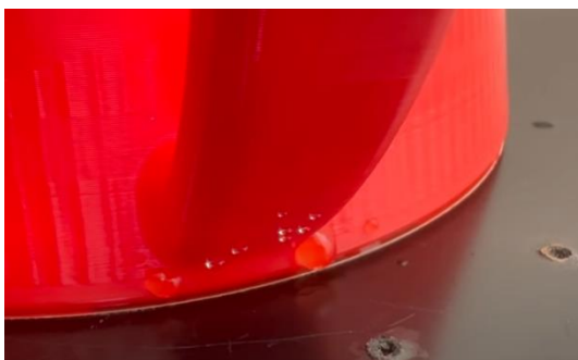
Dikte: 1 laag. Aan de buitenkant van de print ontstaan waterdruppels.
