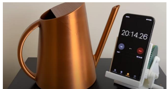
Dikte: 2 lagen. Na 20 minuten zijn er nog geen waterdruppels te bekennen.
