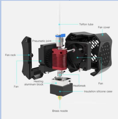
Figuur 25: Onderdelen in een print head
