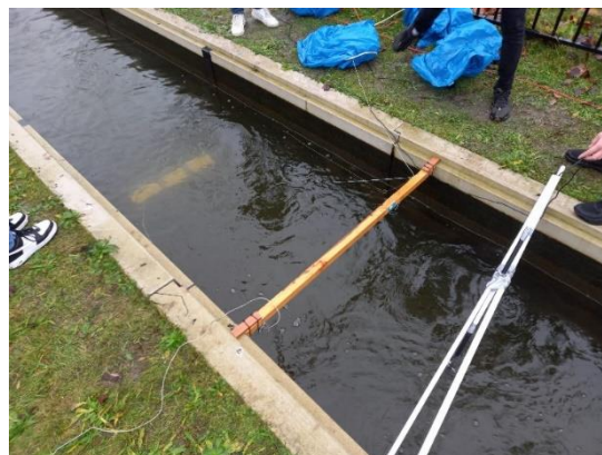
Figuur 14: Stroomgoot met rechts de snelheidsmeter en links de krachtmeters met het 3D model.
