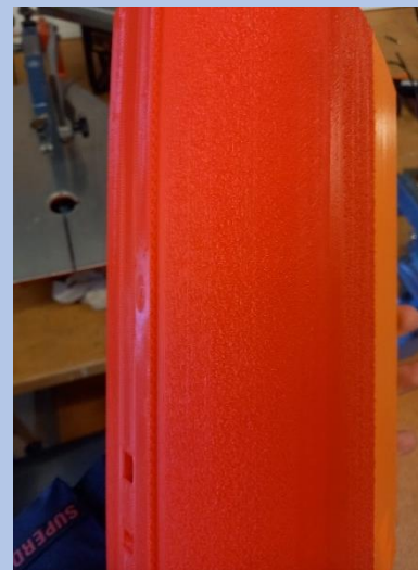
Figuur 26: Bubbeltjes in de oppervlakte van de vleugelvorm
