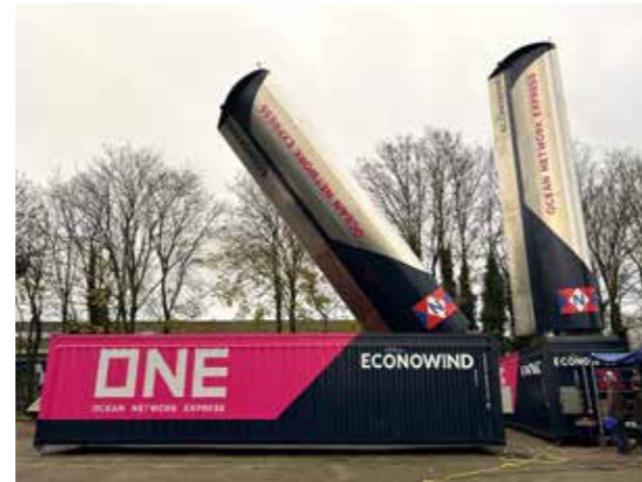
A. Concept ontwerp van zeilen op en in een container door Econowind
