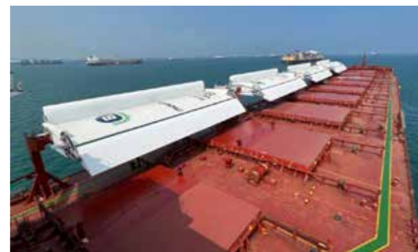
C. 300 meter lange bulkcarrier Berge Olympus uitgerust met vier WindWings
