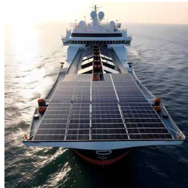
Voorbeeld van zonnepanelen op de voorkant (Bron: Solar Magazine - Wattlab en Blommaert)
